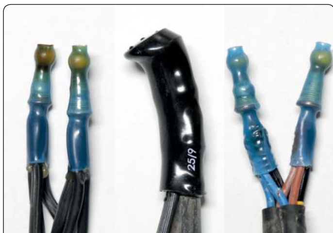
Gauche : correctement fondu/ Droite : pas complètement fondu, pas de colle adhésive visible
